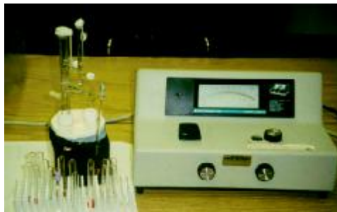
รูปที่ 3 โฟโตมิเตอร์รุ่นที่อ่านค่าออกมาเป็นค่าการดูดซึม หรือค่าการผ่านของแสงแล้วมาเปรียบเทียบความเข้มข้นของอสุจิจากตารางที่หาค่าไว้
